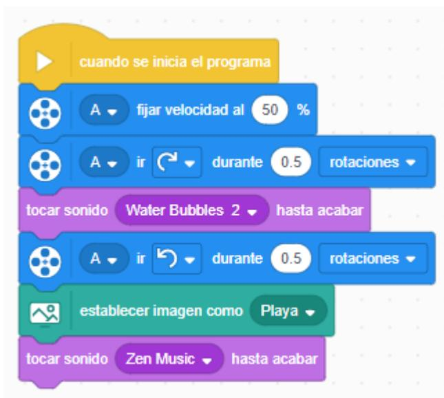
Fijamos el motor que está conectado en el puerto A en un 50% de potencia.
